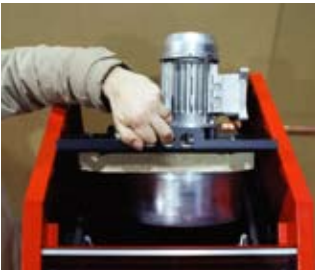
Il Ventilatore con motore ad asse verticale | Vertical intaking fan
